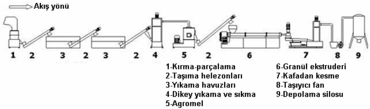
Şekil 1: Geri dönüşüm makinesi üniteleri ve akış şeması
